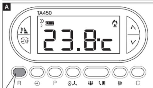
En cas d'anomalies de fonctionnement et d'autres raisons techniques, l'appareil peut avoir besoin d'être remis à zéro.
