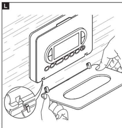
Pour le retrait/remplacement de la plaque, voir la figure **L**.
