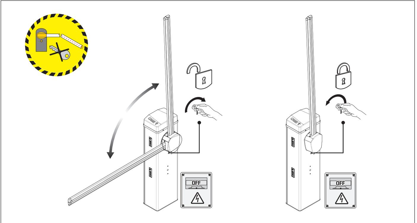
⚠ Pour pouvoir effectuer les opérations d'entretien de la barrière, les ressorts d'équilibrage ne doivent pas être en tension (lisse en position verticale).
