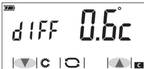
Cette fonction est utile pour les environnements particulièrement difficiles à climatiser, avec des variations de température extrêmes, et permet de commander la mise en marche de l'installation comme indiqué sur la figure **D**.
