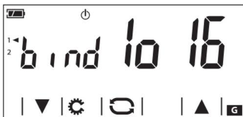
Répétez la procédure pour associer le deuxième actionneur (si présent) au thermostat programmable, en veillant à sélectionner le numéro 2 à la fenêtre **E** avant d'envoyer le code au deuxième module.
