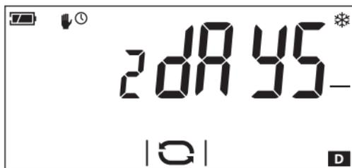
Après expiration de la durée définie, le dispositif se remettra à fonctionner en mode automatique. Pour arrêter le mode manuel temporisé, il suffit de changer de mode en appuyant sur le bouton .
