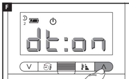
Se servir des boutons  $\wedge \vee$  pour activer/désactiver l'algorithme différentiel **F**.
