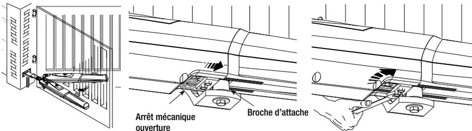
Placez le vantail en position d'ouverture, placez l'arrêt mécanique en butée avec le goujon d'attache et fixez-le.
