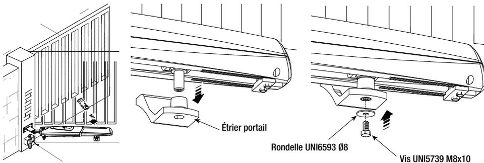
Débloquez le motoréducteur (voir paragraphe déblocage manuel), mettez la porte en position d'ouverture maximale, desserrez les écrous de l'arrêt mécanique d'ouverture, placez-le en butée avec la broche d'attache et fixez-le
