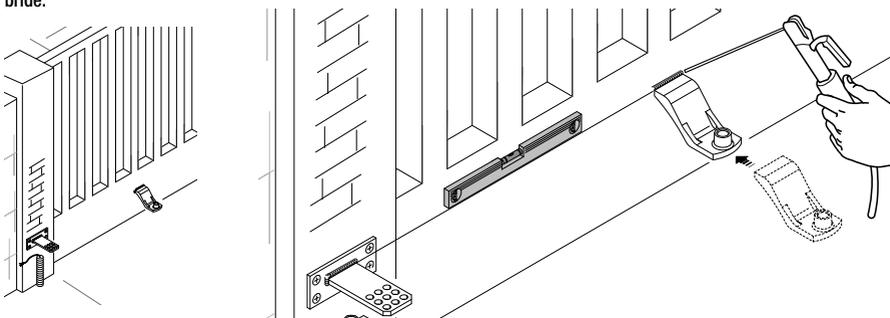
N.B. : sur les portes qui ne sont pas en métal, assemblez et soudez les deux parties de l'étrier et fixez-les avec les vis appropriées.
