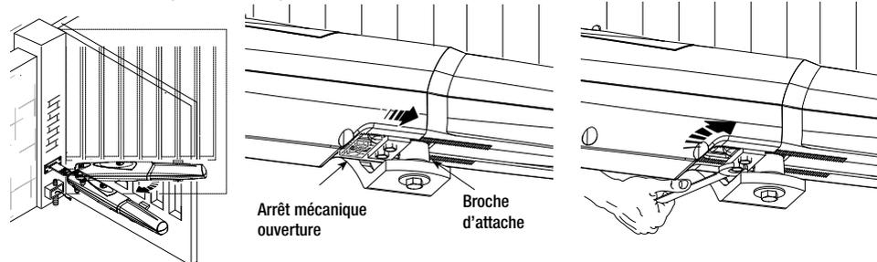
Mettez la porte en position de fermeture, desserrez les écrous de l'arrêt mécanique de fermeture, placez-le en butée avec la broche d'attache et fixez-le.
