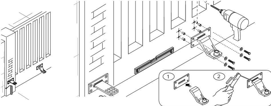
Introduisez la bague (graissée) dans le trou de l'étrier pilier. L'étrier est muni de trous qui permettent de varier l'angle d'ouverture du portail. Fixez la queue à articulation à l'étrier.
