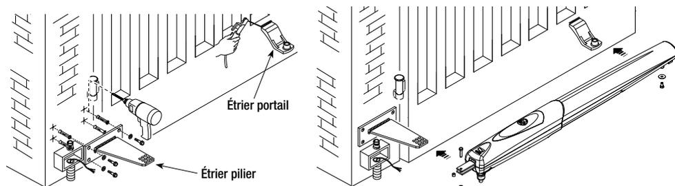
Placez le vantail en position de fermeture, placez l'arrêt mécanique en butée avec le goujon d'attache et fixez-le.
