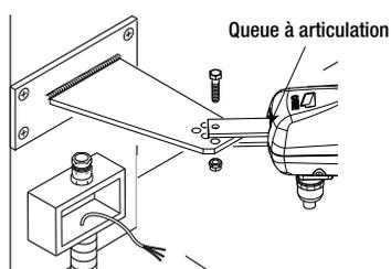
Ouvrez la porte et introduisez la broche dans l'étrier portail et fixez-la avec la rondelle et l'écrou.
